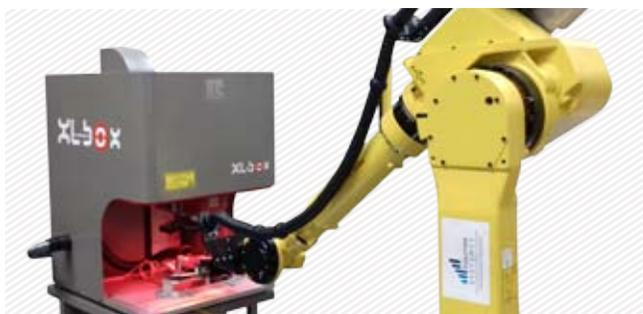
XL-Box Laserstation in Roboterzelle integriert
